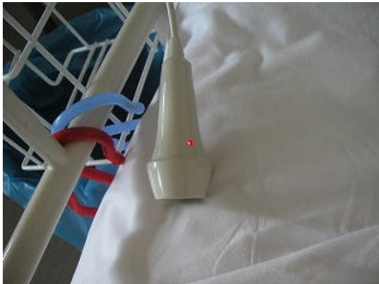
図5 LEDを付けたナースコール Fig.5 Nurse call switch with a LED
