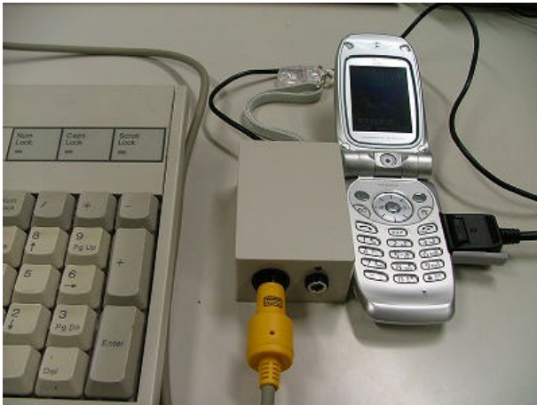
図11 携帯電話用外部キーボードインターフェース Fig.11 Interface between mobile phone and PC keyboard
