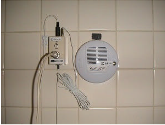
図4 作動スイッチと警報ブザー Fig.4 Operation switch and a buzzer
