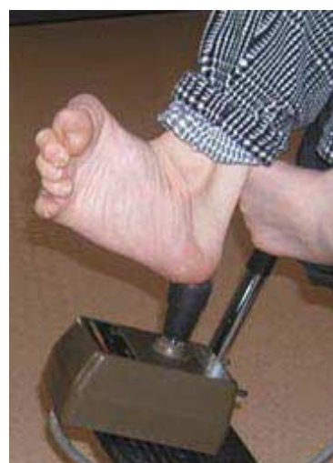
図 12 足によるジョイスティックの操作 Fig.12 Operation of the joystick using foot
