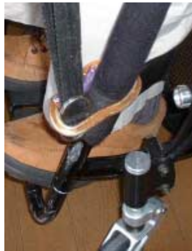
図9 リードの車いすへの取り付け Fig.9 A Leash is attached in a wheelchair
